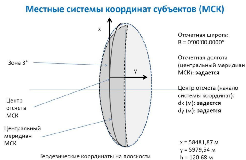
Рисунок 8. Местные системы координат.
