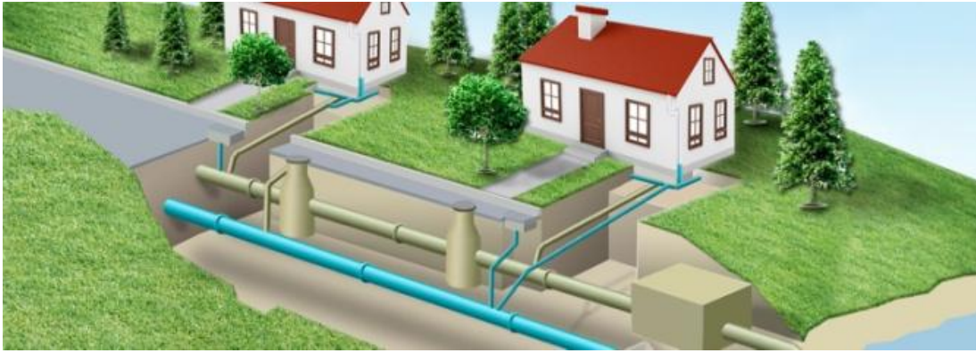
Рис.41. Схема прокладки водопровода и водоотведения в разрезе
