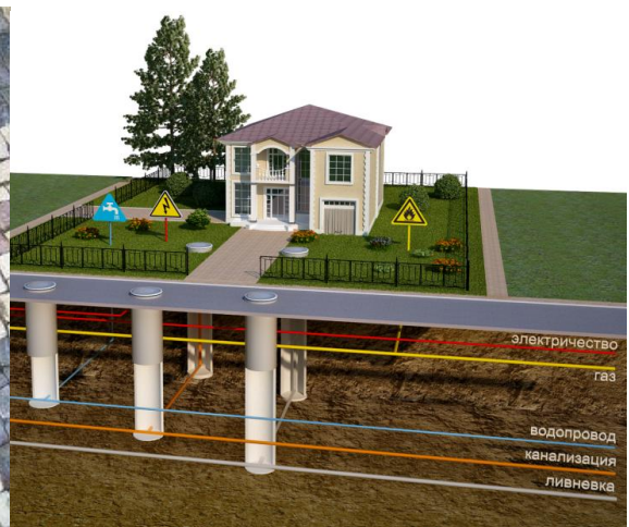
Рис.40. Схема прокладки инженерных сетей в разрезе
